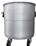
Il materiale viene raccolto all'interno di un contenitore in acciaio inox AISI 304 completo di maniglia in metallo che ne consente lo sgancio, per evitare ogni scintilla che potrebbe essere generata dalla carica elettrostatica. Grazie alle 4 robuste ruote pivotanti, il contenitore può essere spostato con estrema facilità, per poi smaltire il materiale raccolto.
