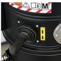
Su un lato della camera è presente uno scuotifiltro manuale ergonomico che consente di pulire il filtro facilmente e rapidamente rimuovendone polvere e detriti dalla superficie. Grazie a questo intelligente sistema di pulizia, l'operatore può continuare a lavorare senza cambiare o lavare il filtro.
