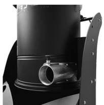
Il bocchettone d'ingresso tangenziale è progettato per facilitare l'abbattimento del materiale aspirato nel contenitore. Un robusto ciclone metallico saldato dentro la camera di filtrazione Permette di ridurre sensibilmente la velocità di ingresso del materiale facendolo cadere all'interno del contenitore. In questo modo si protegge il filtro minimizzando il rischio di intasamento
