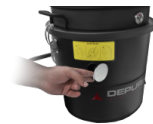
JC Jet Clean Pulizia semiautomatica a contro corrente d'aria, classe M filtro (EN 60335-2-69), 1 filtro cartuccia poliestere, 4 m 2 superficie filtrante, ghigliottina non inclusa
