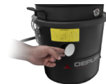
JC Jet Clean Pulizia semiautomatica a contro corrente d'aria, classe M filtro (EN 60335-2-69), 1 filtro cartuccia poliestere, 4 m 2 superficie filtrante, ghigliottina non inclusa
