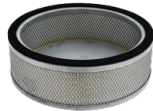
HEPA 14 Filtro assoluto (EN 1822) 22.000 cm 2 superficie filtrante Classe H14 (EN 1822) Fibra di vetro
