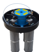
SP Pulizia cartucce in controcorrente d'aria Filtro antistatico classe M (EN 60335-2-69) 4 Filtri poliestere antistatici 12 m 2 superficie filtrante
