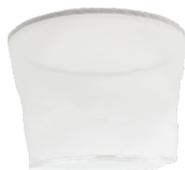
Le liquide aspiré peut être filtré à travers d'un filtre en nylon avec une efficacité de 150 micron. Grâce à ce système, il est possible de séparer aussi des petits copeaux d'huile et recycler les lubrifiants. Le filtre peut être lavé et réutilisé facilement.
