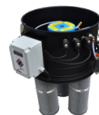
SP Pulizia cartucce in controcorrente d'aria Filtro antistatico classe M (EN 60335-2-69) 3 Cartucce poliestere antistatico 9 m 2 superficie filtrante
