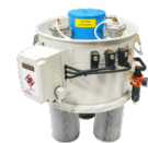
SP Pulizia cartucce in controcorrente d'aria Filtro antistatico classe M (EN 60335-2-69) 3 cartucce poliestere antistatico 9 m² superficie filtrante
