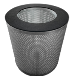
HEPA 14 Filtro assoluto (EN 1822) 110.000 cm 2 superficie filtrante Classe H14 (EN 1822) Fibra di vetro
