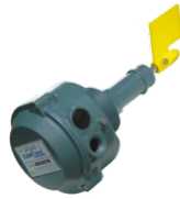
P10166 SENSORE DI LIVELLO ROTATIVO Sensore motorizzato in bassa tensione 24V con paletta rotante, certificato ATEX Z21
