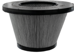
HEPA 13 Absolute filter (EN 1822) 35.000 cm² filter surface H13 Class Filter (EN 1822) Glass fiber
