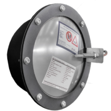
PANOU DIRECȚIONAL PROTEJAT ÎMPOTRIVA EXPLOZIILOR Dispozitiv de ventilare proiectat să se rupă la o anumită presiune și să evacueze presiunea explozivă într-o zonă sigură
