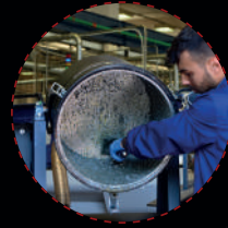
Tiltable discharging hopper
