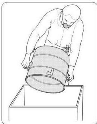
NOTA Lo svuotamento del contenitore può effettuarsi anche tramite il rubinetto di scarico posto sul fondo del contenitore stesso.
