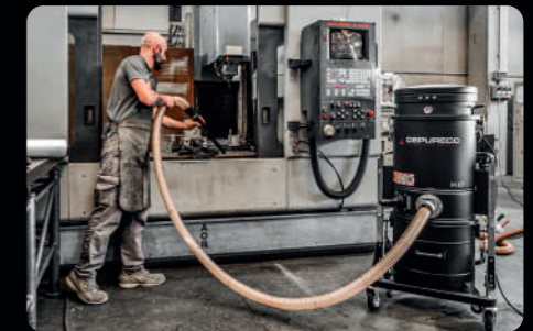
Limpieza de virutas metálicas de máquina CNC
