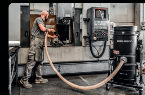
Récupération des copeaux métalliques des machines à commande numérique
