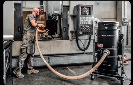
Raccolta trucioli metallici da macchine CNC
