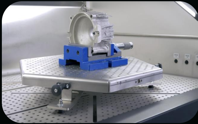
L'interno di una cabina di pulizia
